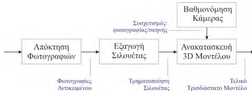
Εικόνα 12. Διάγραμμα ροής ανακατασκευής τρισδιάστατου μοντέλου
