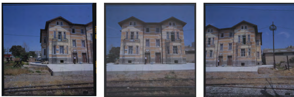
Εικόνα 39. Στερεοσκοπικά ζεύγη για την επεξεργασία σε ΨΦΣ
