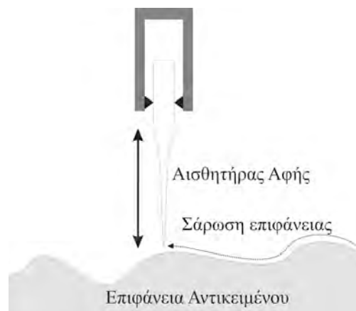
Εικόνα 29. Αποτύπωση τρισδιάστατης γεωμετρίας με χρήση αισθητήρα αφής
