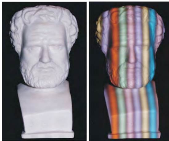
Εικόνα 16. Προβολή χρωματικά κωδικοποιημένου μοτίβου
